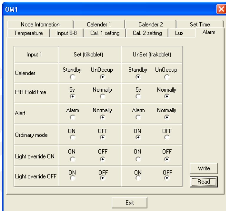
Der kan til nogle Netlon software tilsluttes alarmanlæg. Det er dog ikke alle alarmanlæg, der kan kommunikere på LON FTT10 bussen. Derfor kan man via et relæ fra alarmanlæg til OM1 input 1 få OM1 applikationen til at give dette LON signal.
