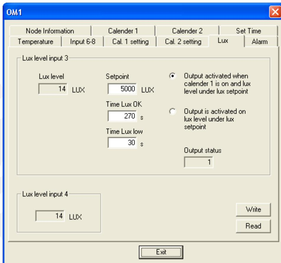
Det er muligt at tilslutte to lux sensorer af typen Micromatic-Netlon lux sensor. Disse sensorers aktuelle måling udlæses i de to vinduer benævnt Lux level.
